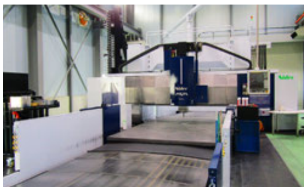
上：山口直人社長。下：導入した3m×6mの門型五面加工機。大型ながら100分の1ミリの精度を出すことが可能。
